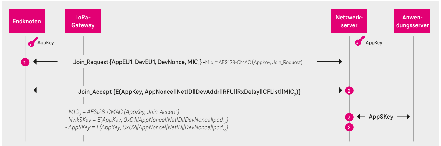
Abbildung 4: OTAA-Registrierungsprozess eines LoRaWAN-Geräts [9]
