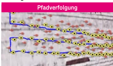
Vergleich der Standard-GNSS- und Precise-Positioning-Lösung in Pfadverfolgungs- und Andocktest Rote Punkte – Positionsbestimmung mit Standard-GNSS Gelbe Punkte – Precise Positioning
